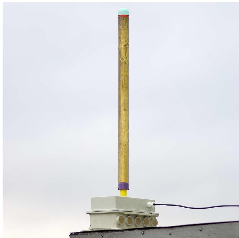
Photo 12: VLF elektrivälja antenn koos eelvõimendiga.
