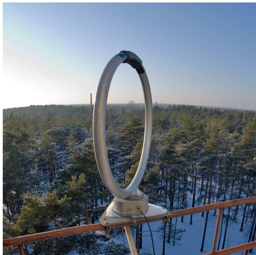
Photo 13: VLF magnetvälja antenn (raamantenn).
