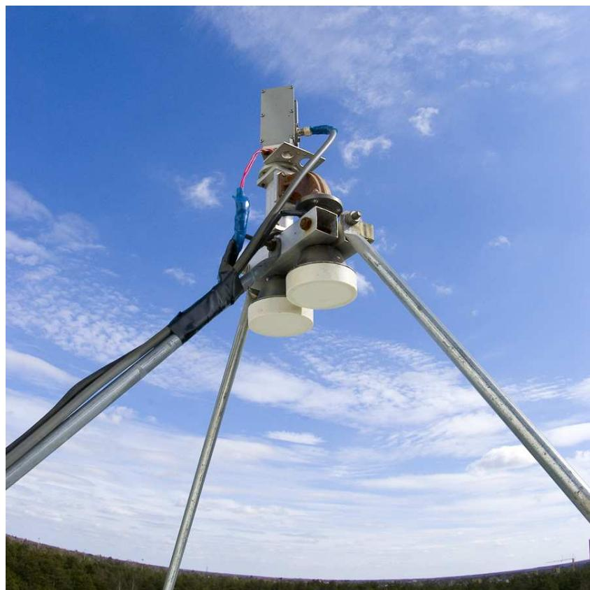
Photo 6: Kaks *feedhorn*'i, ferriitümberlüliti ja LNA lähedalt vaadatuna.
