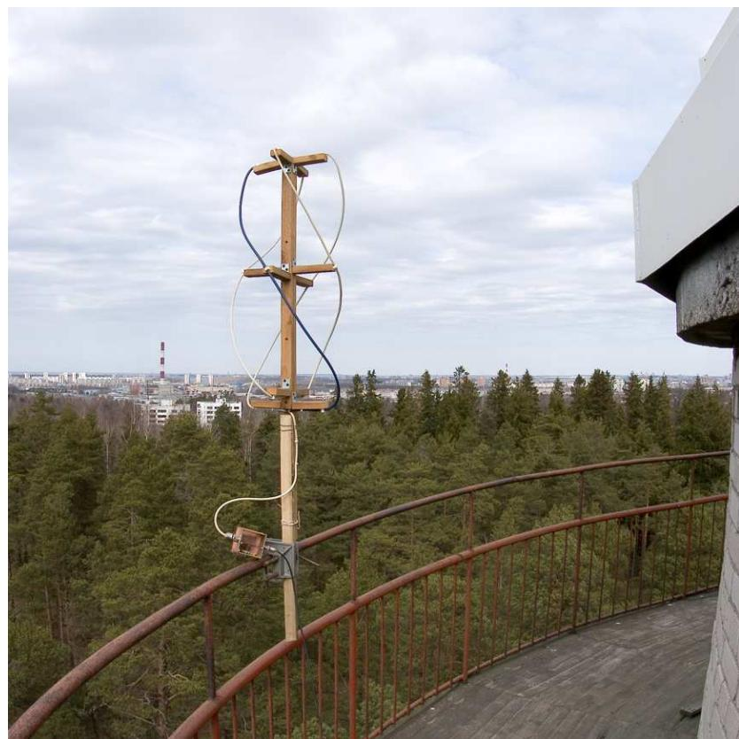
Photo 17: Meteoroloogiliste satelliitide (NOAA polar orbiting satellites, APT) „DNA” tüüpi vastuvõtuantenn.
