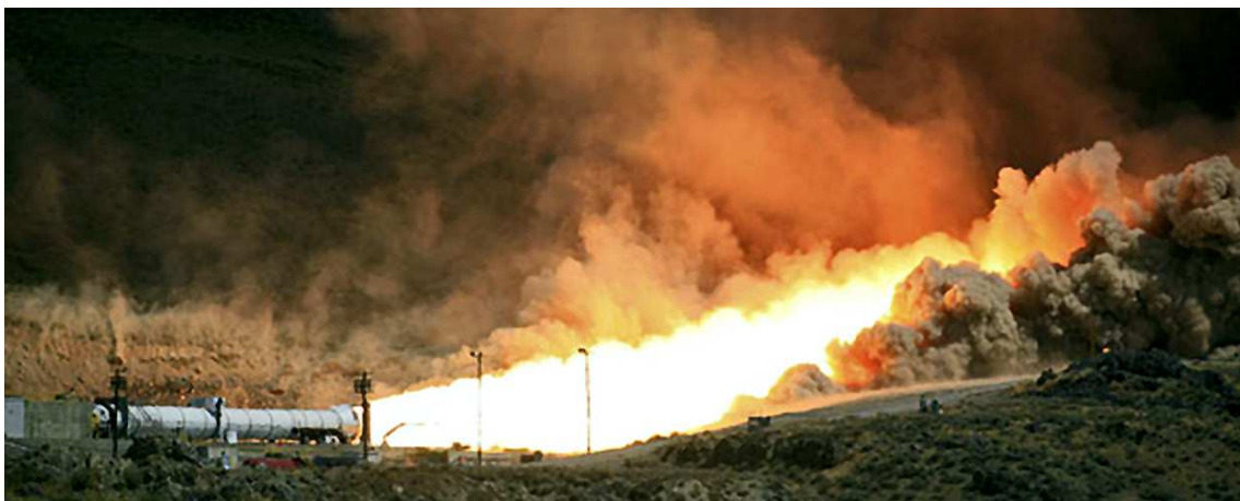
Foto 1: Kanderaketi „Ares-1“ esimese astme TKRM-i maapealsed katsetused
