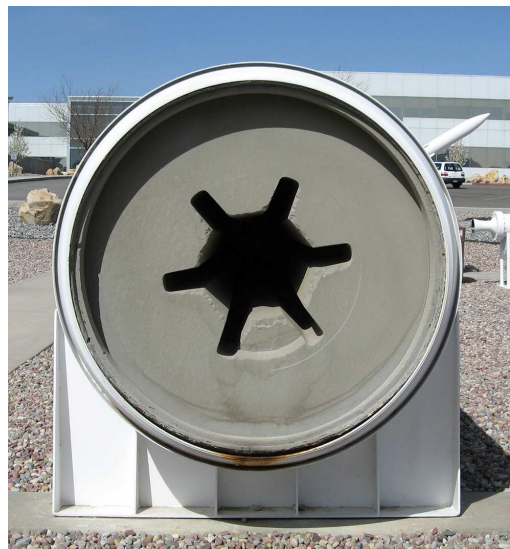
Foto 4: Tahkekütusega stardikiirendi sisemine kanal (kontinentidevahelise ballistilise raketi Minuteman esimese astme mootor)
