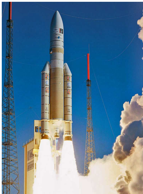
Foto 3: Euroopa rakett „Ariane-5“ on ülesehitatud sama skeemi järgi mis „Space Shuttle“: oluline osa tõukejõust stardil saadakse kahe tahkekütuse kiirendiga
