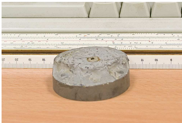
Foto 6: Sarnane diafragma kui fotol 3, kuid arvatavasti seinast väljakoukimisel rikutud
