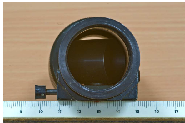
Foto 5: Katik on suletud, et auk seinas ei helendaks kui vaatleja silm ei kata okulaari kinni
