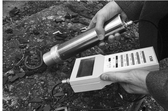
Pilt 1: Uuringud ' \gamma -Mapperi ' eelmise mudeliga - ei tea, kas see rauatükk ka aktiivne on...
