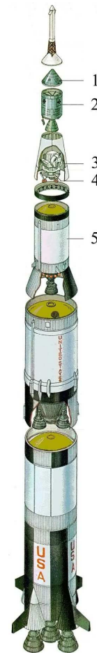
Joonis 5: „Apollo-12“ kompleksi skeem: 1, 2: orbitaallaev „Apollo“ (meeskonna- ja abimoodul); 3. Kuumooduli adapter; 4. Kuumoodul; 5. Raketi kolmas aste S-IVB
