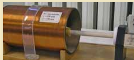
Solenoidi töö füüsika-praktikumis. Sisuliselt on see kaadervärk südamikuta trafo, mille mähised on teineteise suhtes nihutatavad. Mida näitab voltmeter teise mähise küljes, kui suuremale mähisele lülitada alalispinge allikas?
