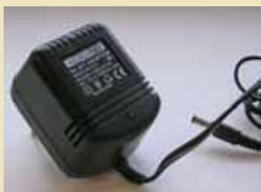
Selle "seinaadapteri" sees on samuti trafo. Lisaks alaldussild 4-st diodist ja pinget siluv elektrolüüt-kondensaator. Kuigi kirjade järgi peaks väljundis olema pinget 12V, näitab tester 17V kanti. Ilma koormuseta peabki nii olema, sest 12V on efektiivväärtus, koormuseta mõõdamise aja amplituudväärtuse, mis on eelnevast 1,4 (SQRT 2) korda suurem.
