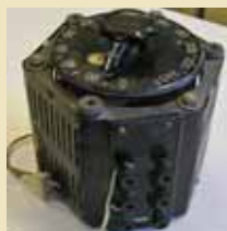
Autotrafo ehk induktiivpool, mille ühe väljaviigu asukoht ja seega ka pingetemal on muudetav.
